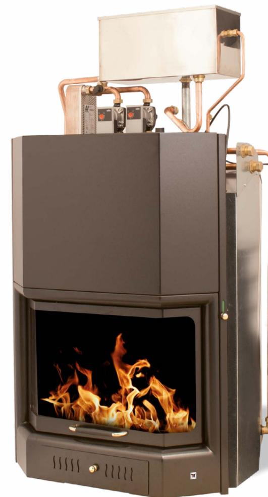
**TERMOCAMINO SERIE DUAL**, completo di porta con apertura sia ad anta che a scomparsa, ed impianto idraulico premontato. Dotazione: nr. 2 circolatori ad alta efficienza, scambiatore da 1", vaso di espansione in acciaio inox, galleggiante rinforzato, valvola sfiato aria automatico, valvola sicurezza 3 bar, flussostato acqua sanitaria, sensore pressione, rubinetto di scarico e tubi di collegamento in rame con uscite sia a destra che a sinistra, centralina elettronica.
