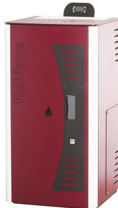
LE TERMOSTUFE DA LOCALE TECNICO IDRO A PELLETTA MODELLI KALDYNA, sono dotate di estrattore fumi, centralina elettronica, display lcd, motoriduttore, pressostato fumi, impianto idraulico, valvola sicurezza 3 bar, rubinetto carico impianto, rubinetto scarico impianto, circolatore alta efficienza, sensore pressione, termostato a riarmo manuale.
