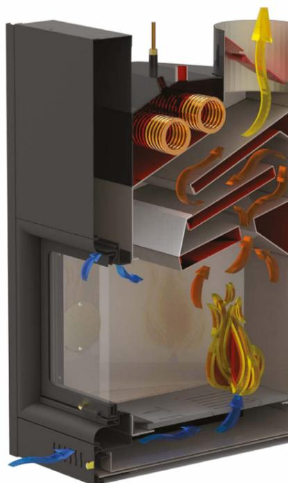
**TERMOCAMINO SERIE MONO** abbinabile ad impianto a circuito aperto, completo di porta prismatica con apertura sia a scomparsa che ad anta.
