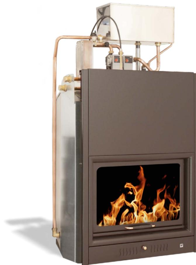
**TERMOCAMINO SERIE DUAL**, completo di porta con apertura sia ad anta che a scomparsa, ed impianto idraulico premontato. Dotazione: nr. 2 circolatori ad alta efficienza, scambiatore da 1", vaso di espansione in acciaio inox, galleggiante rinforzato, valvola sfiato aria automatico, valvola sicurezza 3 bar, flussostato acqua sanitaria, sensore pressione, rubinetto di scarico e tubi di collegamento in rame con uscite sia a destra che a sinistra, centralina elettronica.
