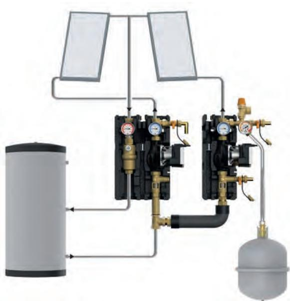
La stazione a 3 linee può essere impiegata in un impianto con campi collettori separati indipendenti (impianti a 2 tetti). Per il passaggio tra i campi collettori vengono accese le pompe. Questa disposizione consente il funzionamento in parallelo di entrambi i campi collettori.
