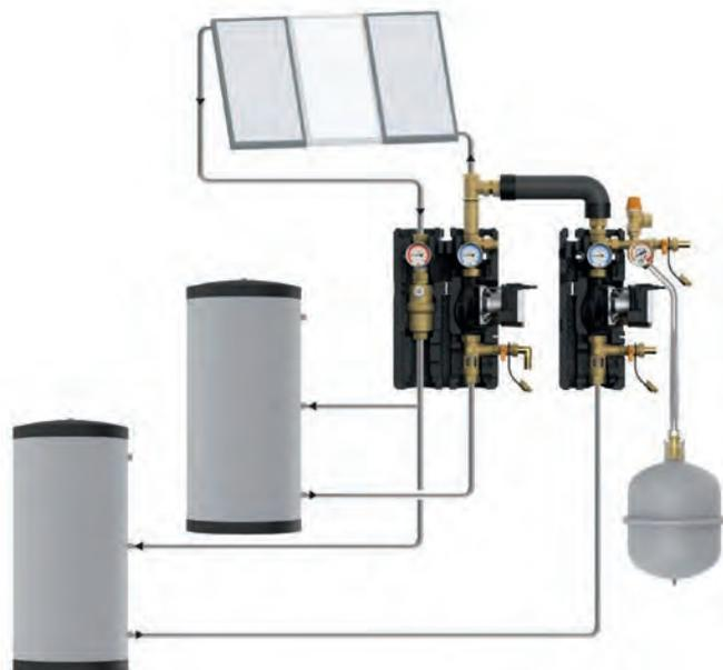
La stazione a 3 linee può essere impiegata in un impianto con 2 accumulatori. Le pompe vengono attivate per la commutazione tra gli accumulatori. Questa disposizione consente il caricamento parallelo di entrambi gli accumulatori.
